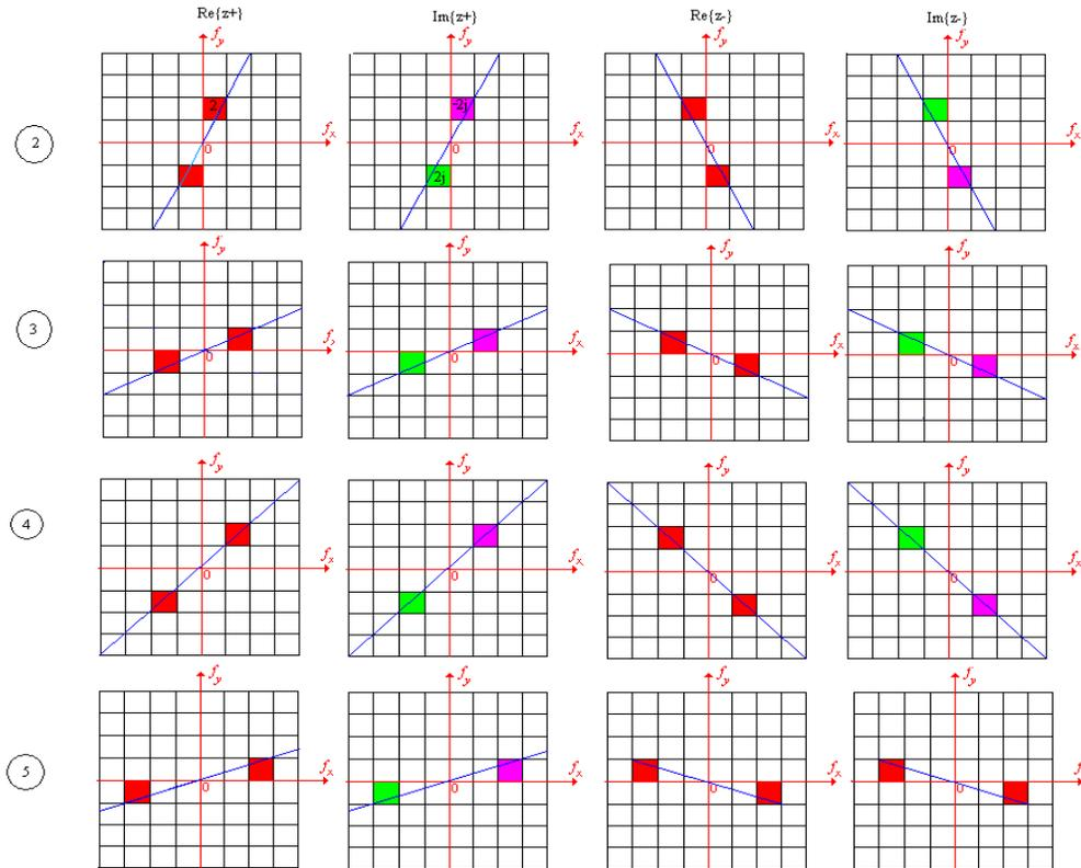
Figure 6. HWPT can separate the directions of angles  $\arctg(1/2)$ ,  $\arctg(1)$ ,  $\arctg(1/3)$ ,  $\arctg(2)$  from the directions of angles  $-\arctg(1/2)$ ,  $-\arctg(1)$ ,  $-\arctg(1/3)$ ,  $-\arctg(2)$ .
